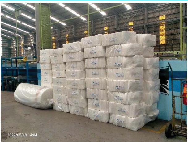
รูปที่ 3-18 ถุงกรองสำรอง สำหรับระบบ Baghouse
